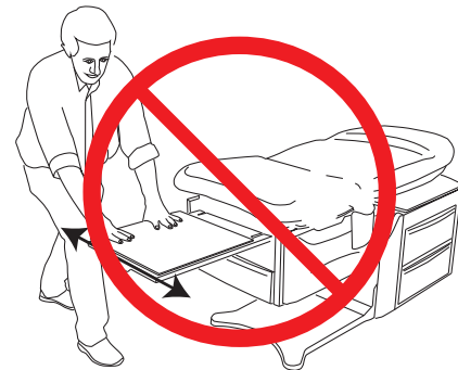
Figure 17. Ne pas sortir complètement le repose-jambes pour déplacer
