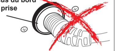
La prise de la de la commande au pied n'est pas complètement insérée
