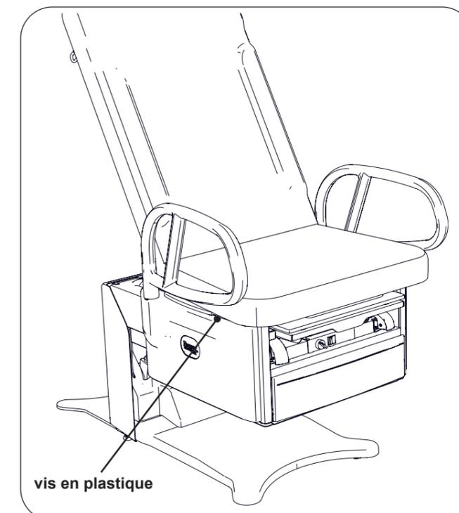
Figure 31. Emplacement de la vis d'arrêt en plastique blanc
