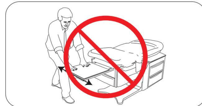
Figure 17. Ne pas bouger avec le support de jambe complètement étendu
