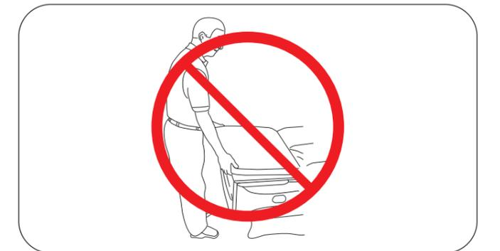
**Figure 13. Do Not Lift par le coussin**
