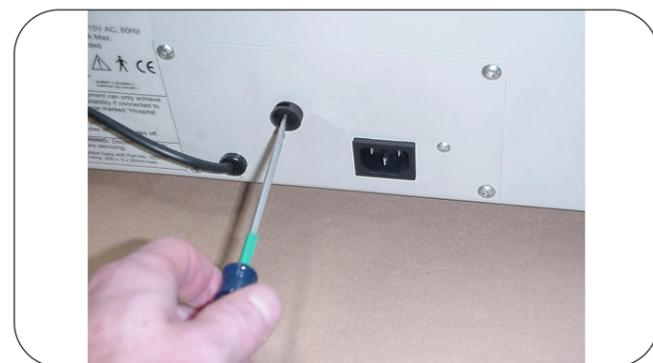
Figure 52. Les tables avec prise et tiroir chauffant utilisent un seul fusible de 3A
