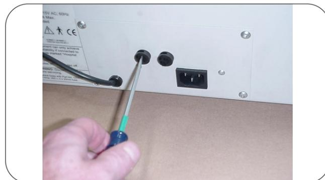
Figure 53. Les tables avec tiroir chauffant et sans prise utilisent deux fusibles de 1A
