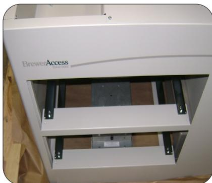
**Figure 17. Tiroir inférieur déplacé pour montrer l'emplacement du fusible**
