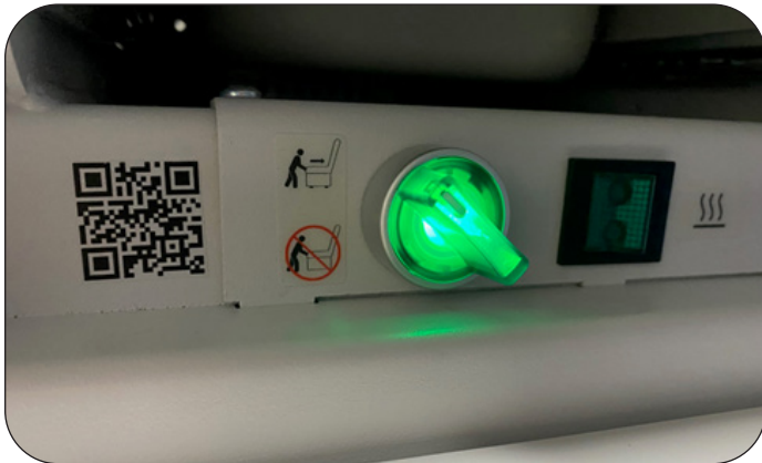
Figure 41. Commutateur de l'option de mobilité EasyGlide
