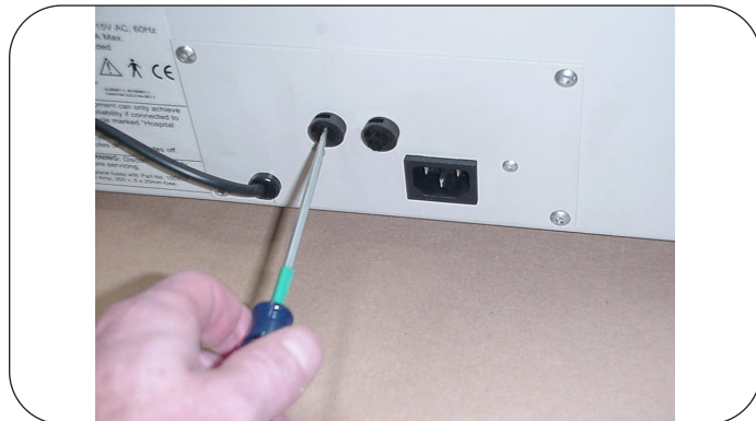
Figure 53. Les tables à tiroir chauffant mais sans prise électrique utilisent deux fusibles de 1 A
