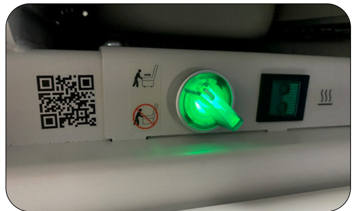
Figure 49. Commutateur de l'option de mobilité EasyGlide
