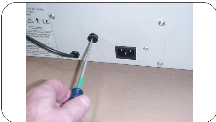
Figure 52. Les tables à prise électrique et tiroir chauffant utilisent un fusible unique de 3 A
