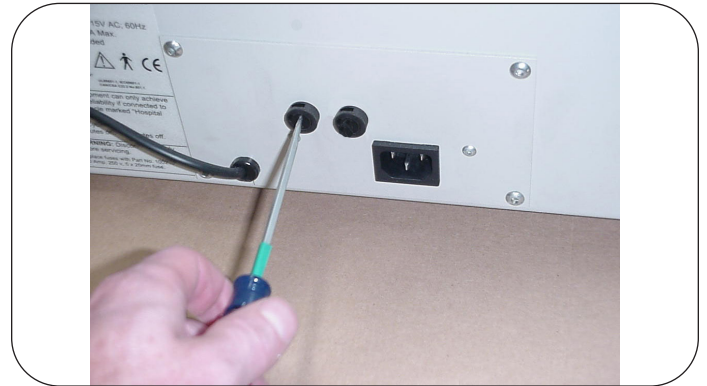
Figura 53. Las mesas con calentador de cajón y sin tomacorriente usan dos fusibles de 1 A
