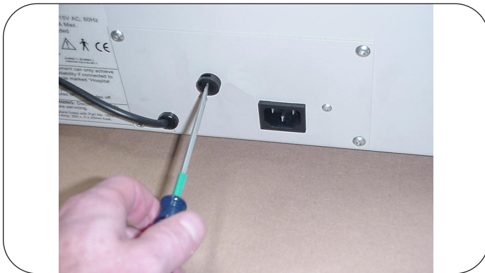
Figura 52. Las mesas con tomacorriente y calentador de cajón usan un fusible simple de 3 A
