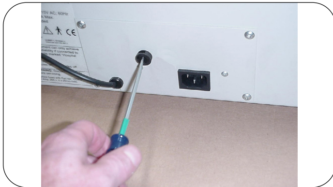
Figura 52. Las mesas con tomacorriente y calentador de cajón usan un fusible simple de 3 A
